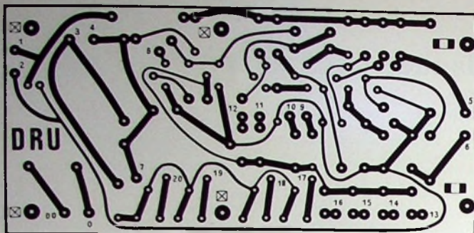
Bild 4. Printplatte für den photoelektronischen Drehzahlmesser (Maßstab 1:2)
